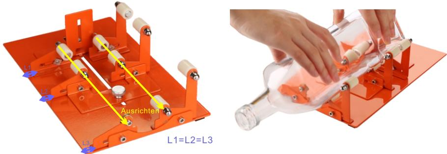
(2) Stellen Sie die Klinge praktisch gerade nach oben mit einer kleinen Neigung nach vorne, damit sie mit dem Glas in Kontakt bleibt. Drehen Sie die Flasche fest, um festzustellen, ob die Klinge permanent mit dem Glas in Kontakt bleibt; wenn nicht, stellen Sie die Klinge so ein, dass dies der Fall ist.
