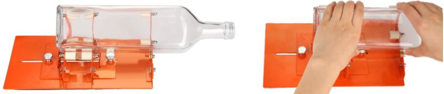
(3) Jetzt wird der flache Oberflächenbereich der Flasche angerissen. Wenn Sie die flache Oberfläche der quadratischen Flasche anreißen, sollten Sie die Klinge senkrecht platzieren, sodass die Klinge immer in Kontakt mit dem Glas bleibt.
