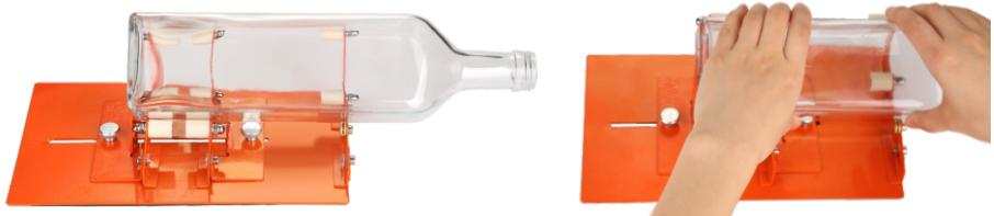
(3) Maintenant, graver les surfaces plates de la bouteille. Lorsque vous gravez la surface plane de la bouteille carrée, placez la lame à la verticale afin que la lame reste toujours en contact avec le verre.
